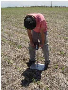
***Medición a campo de la resistencia mecánica del suelo a través de un penetrómetro digital con datalogger.***
